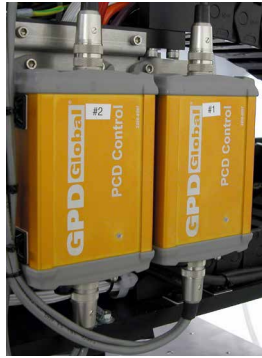
图6: 两个控制接口单元安装在设备上
